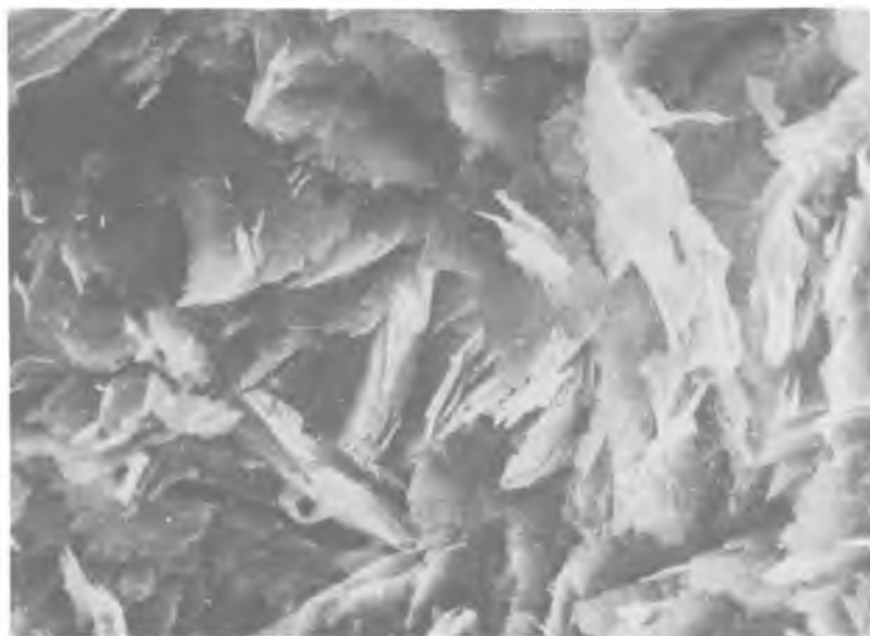
Сл. 2. Скенинг електронски снимак \times 2000\times . Листасти агрегат талка Рајца. Fig. 2. Scanning electron photograph \times 2000\times . Laminated aggregate of the Rajac talc.
